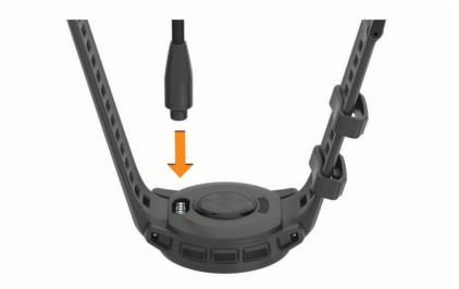
2 Conecta el extremo grande del cable USB a un puerto de carga USB. El reloj muestra el nivel de carga actual de la batería.
